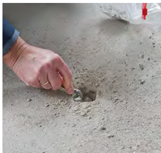
Paso 1: La muestra se toma como de costumbre a lo largo de toda la sección transversal del recredido y se introduce en una bolsa.
