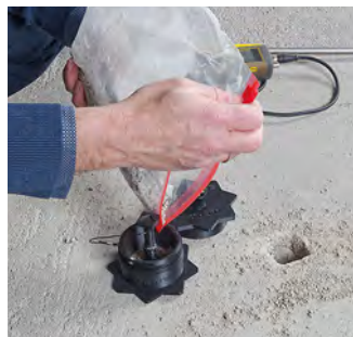
Paso 3: Llenar la cámara de medición con la muestra de material.
