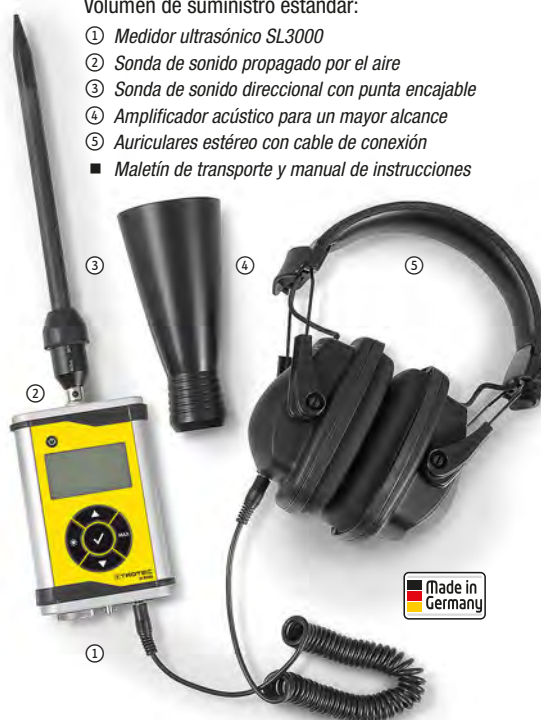
La sonda de sonido propagado por estructuras sólidas con punta de acero inoxidable resulta ideal para pruebas no destructivas como los controles de desgaste de rodamientos en piezas de máquina giratorias.
