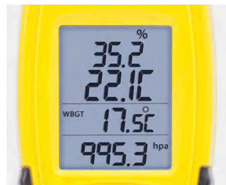
La LCD del TC100, con iluminación de fondo, muestra simultáneamente cuatro magnitudes de medición que pueden ser leídas incluso en entornos poco iluminados.
