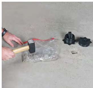
Paso 2: Trituración del material de la muestra de manera que todo el material de prueba tenga un tamaño de grano no superior a 8 mm.
